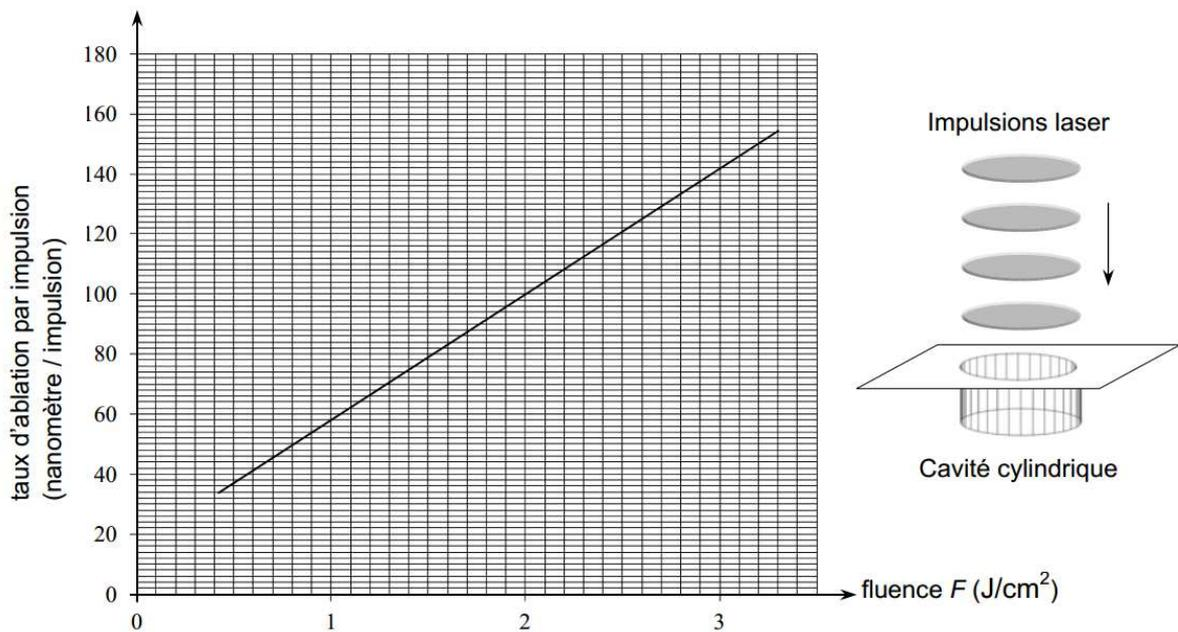
On admettra, comme le montre les schémas ci-dessous, que la profondeur totale  $p$  de la cavité gravée est proportionnelle au nombre d'impulsions reçues et donc à la durée  $\Delta t$  de la gravure.
