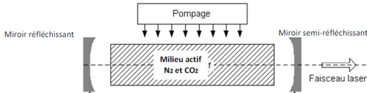
Les photons émis par émission stimulée dans la cavité sont sélectionnés selon une seule direction de propagation ; ils se réfléchissent sur les miroirs et initient d'autres émissions stimulées. En moyenne 1% du nombre total de photons ayant frappé le miroir semi-réfléchissant s'en échappent.
